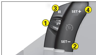
Este dispositivo de ajuda à condução permite selecionar uma velocidade máxima. A velocidade deve ser superior a 30 km/h.
